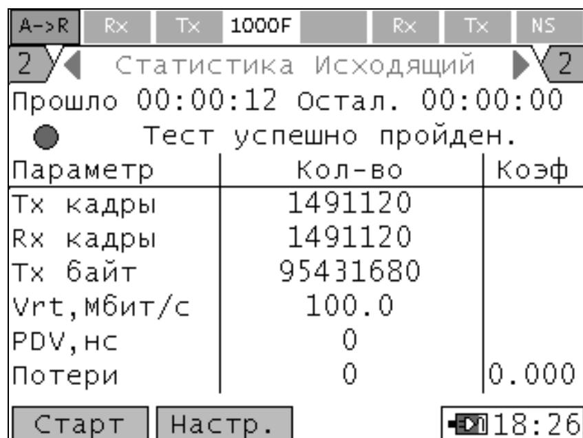
Рисунок 10.10. Тест трафика для асимметричных каналов
