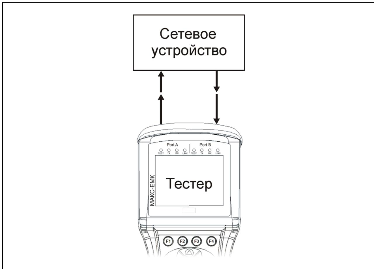
Рисунок 10.7. Схема «В» подключения прибора в режиме одностороннего тестирования
