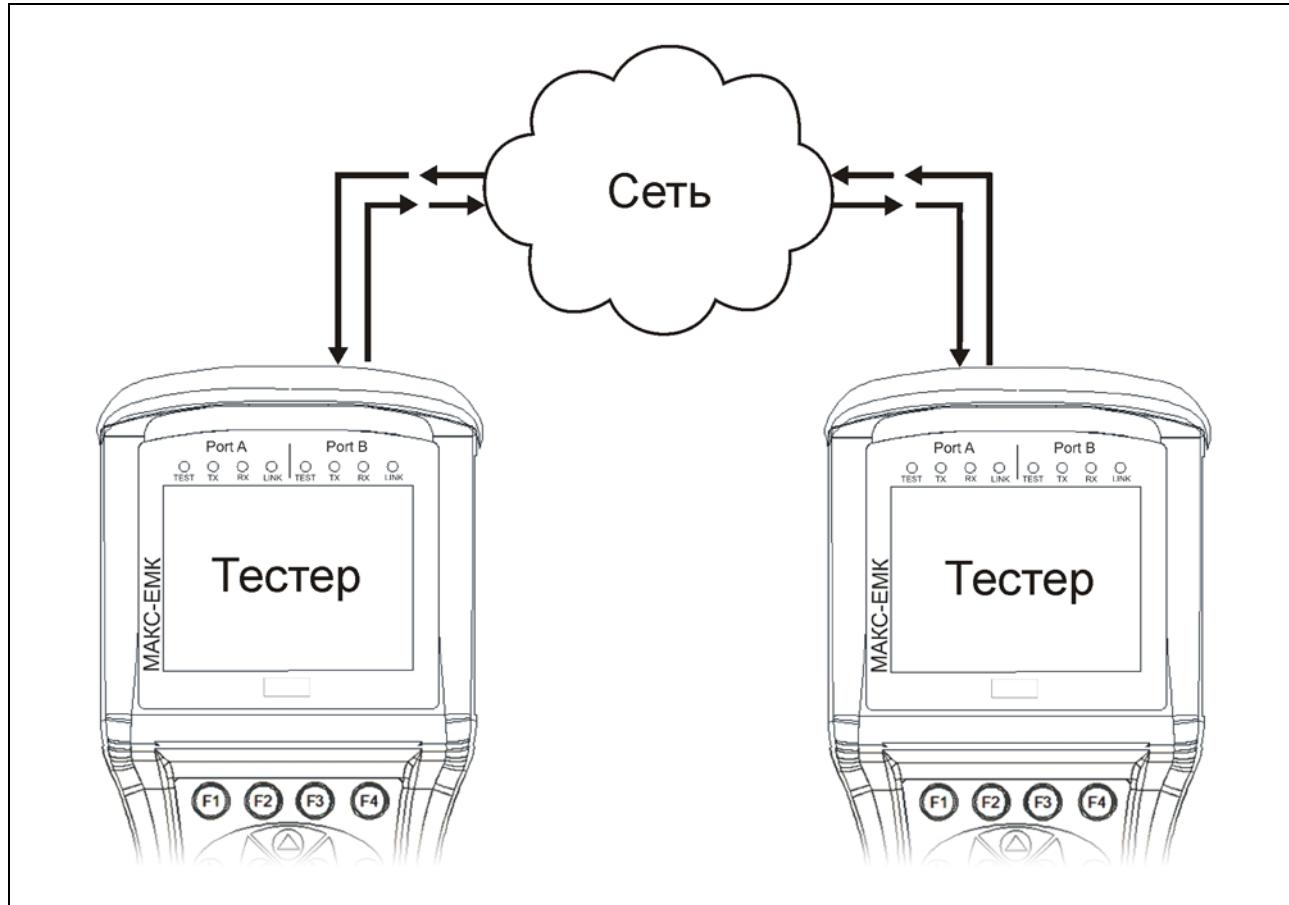
Рисунок 10.8. Схема «С» подключения прибора в режиме тестирования ассиметричных каналов
