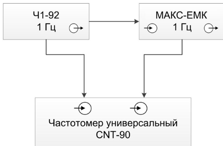
Рисунок 11.2. Схема определения абсолютной погрешности измерения интервалов времени
