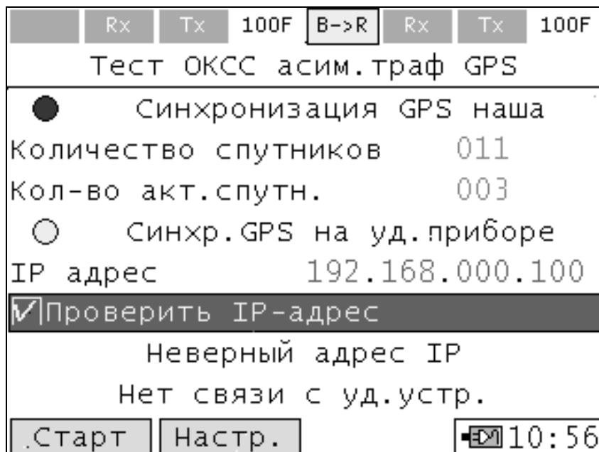
Рисунок 10.36. Тест оценки качества сетей связи 1-я страница режима теста при синхронизации от ГНСС – случай, когда 2-й прибор отсутствует
