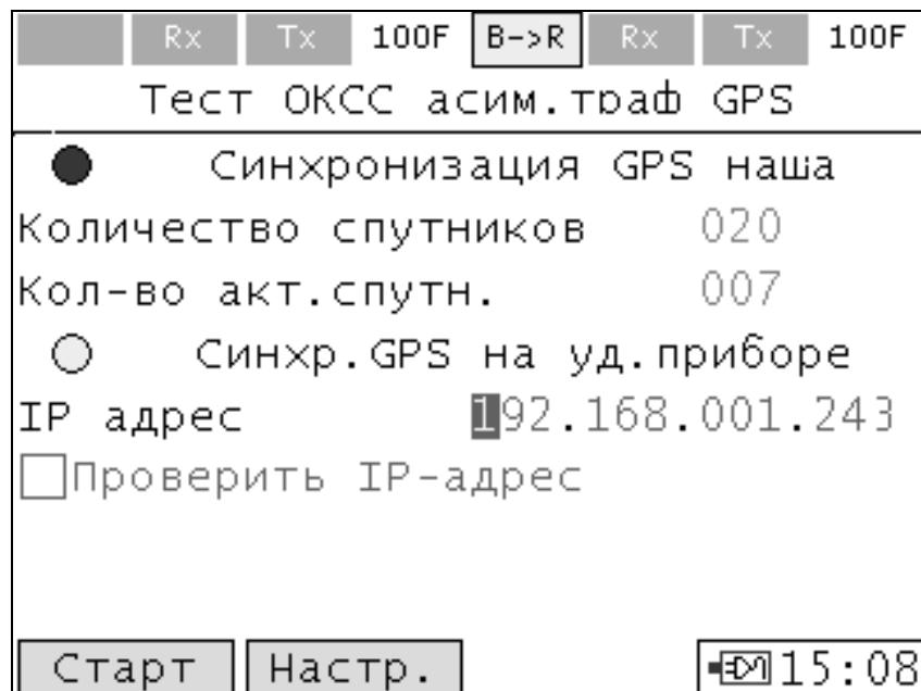
Рисунок 10.37. Тест оценки качества сетей связи 1-я страница режима теста при синхронизации от ГНСС. Когда обе иконки в полях статуса синхронизации горят зеленым, можно начинать тест.
