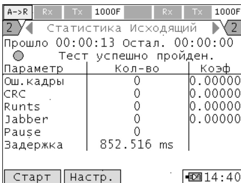
Рисунок 10.11.2. Тест трафика для асимметричных каналов, нижняя часть
