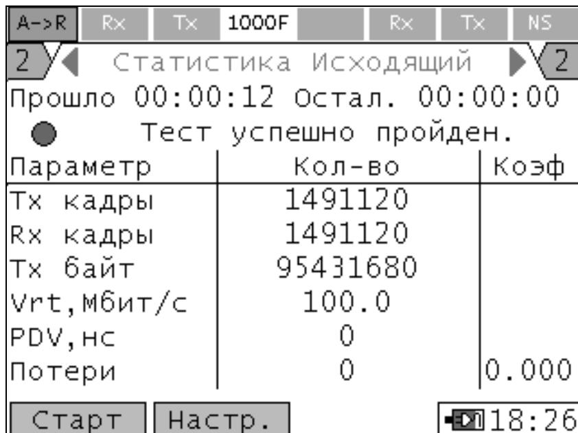
Рисунок 10.11.1. Тест трафика для асимметричных каналов, верхняя часть
