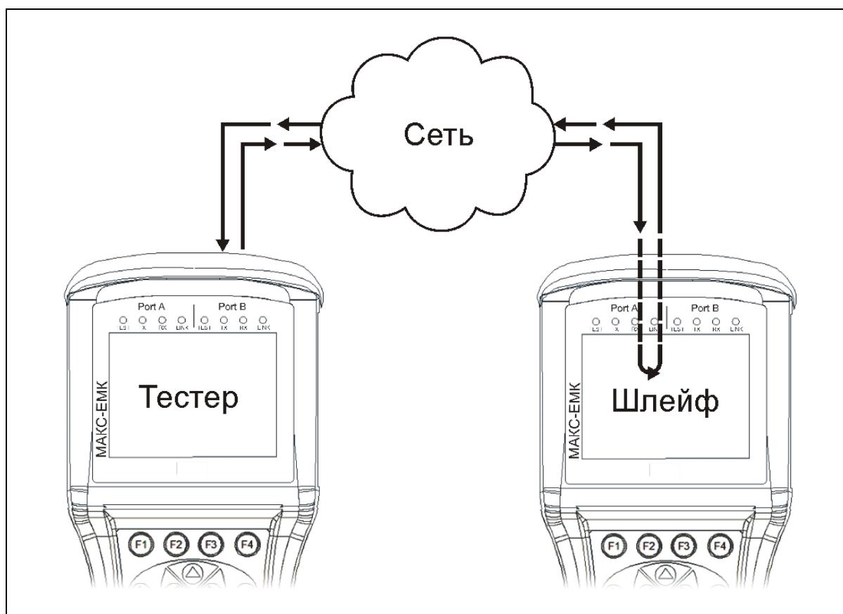
Рисунок 10.7. Схема «А» подключения прибора в режиме тестирования симметричных каналов
