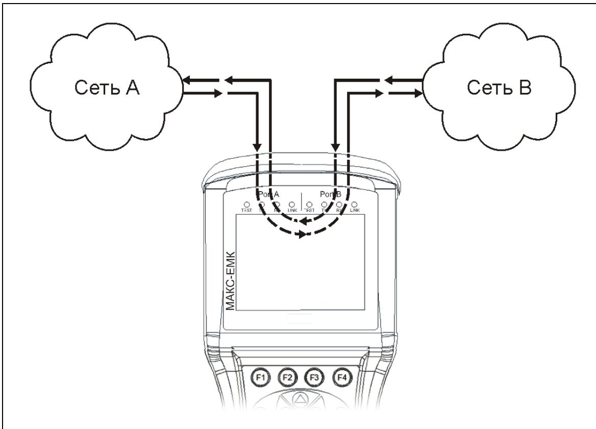
Рисунок 10.47. Схема подключения в режиме Транзит
