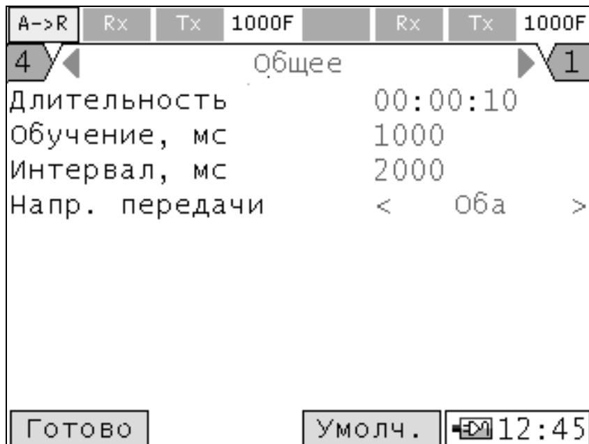
Рисунок 10.44.1 Общие настройки Теста оценки качества сетей связи при синхронизации от PTP
