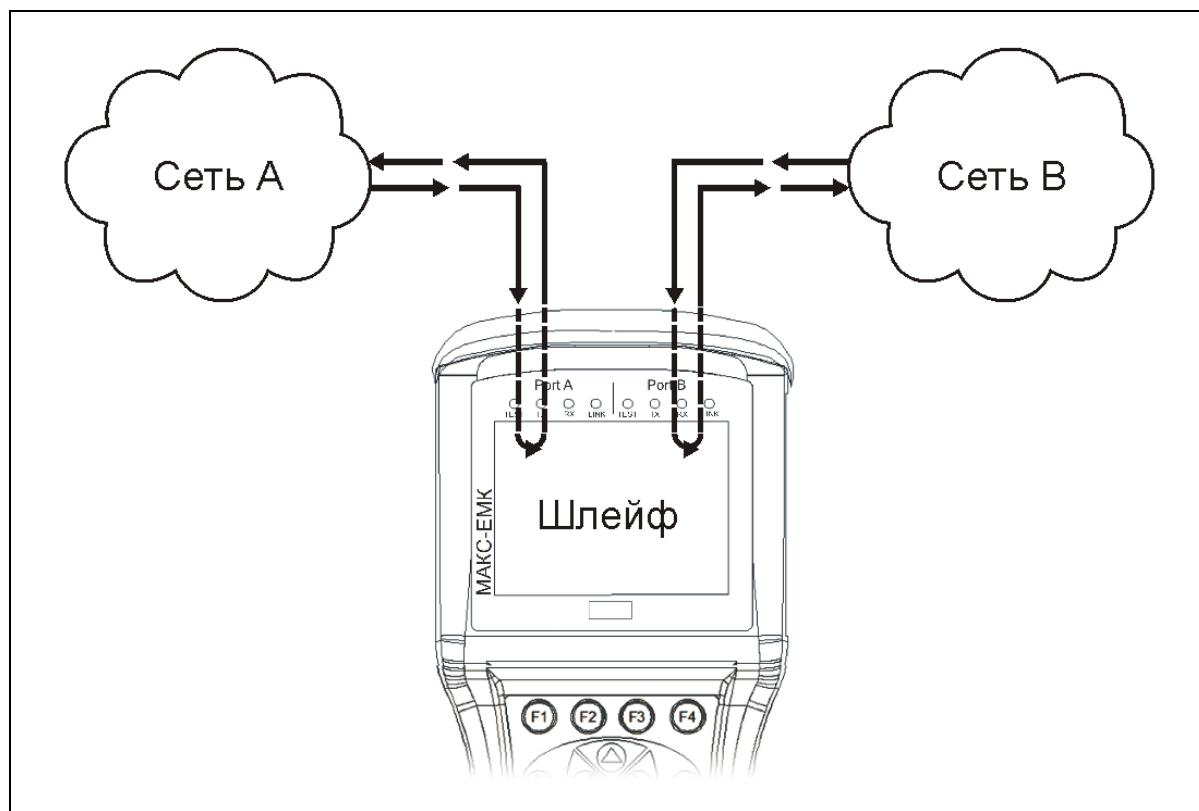
Рисунок 10.46. Схема подключения в режиме Шлейф
