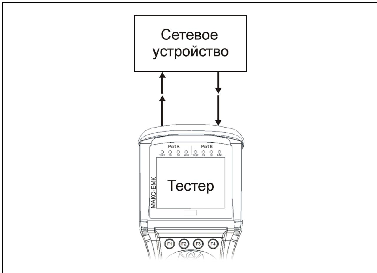
Рисунок 10.8. Схема «В» подключения прибора в режиме одностороннего тестирования
