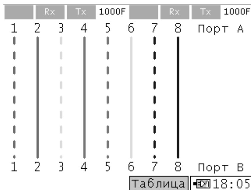
Рисунок 10.26. Диагностика медного кабеля. Схема коммутации
