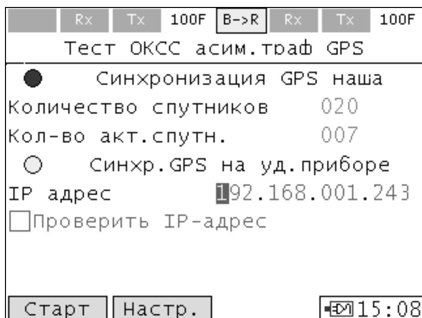
Рисунок 10.35. Тест оценки качества сетей связи 1-я страница режима теста при синхронизации от ГНСС
