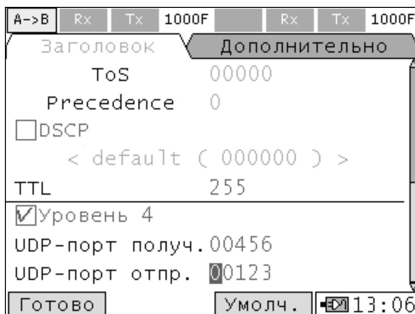
Рисунок 10.10.2 Настройки теста трафика, нижняя часть.
